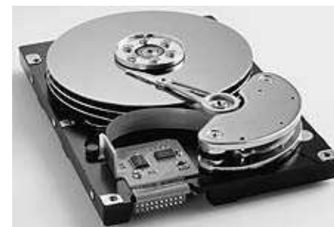
Rys. 2.5 Mechanizm dysku z ruchomymi głowicami
